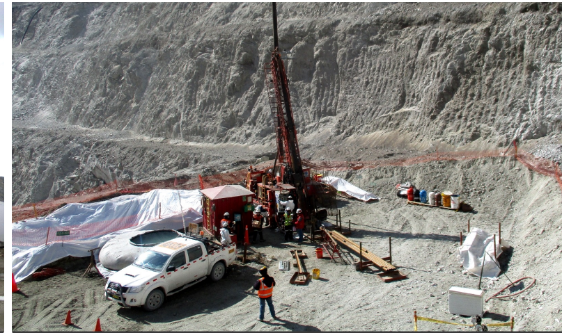
PLATAFORMAS PARA PERFORACIONES COMPAÑIA MINERA ANTAMINA OPERACIÓN MINA – CAMPAMENTO YANACANCHA.
